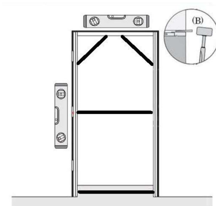
**ATTENTION :** le cadre devra être posé en saillie de 2 mm par rapport à la cloison pour permettre l'application de la bande calicot et de l'enduit de ratissage. La porte sera ainsi totalement à fleur de la cloison finie.
