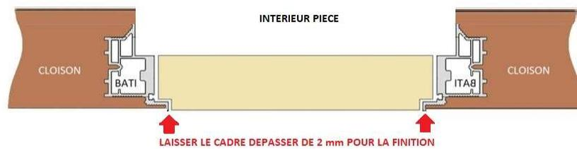
2. Utilisez les pattes de scellement (fournies) pour sceller le cadre à votre cloison pleine (brique) ou collez-le avec de la colle de construction polyuréthane (placo). Exemple de mousse PU : **RUBSON FIX EXPRESS - WURTH PURE LOGIC COLLE MOUSSE PU - RECTAVIT EASY FIX**
